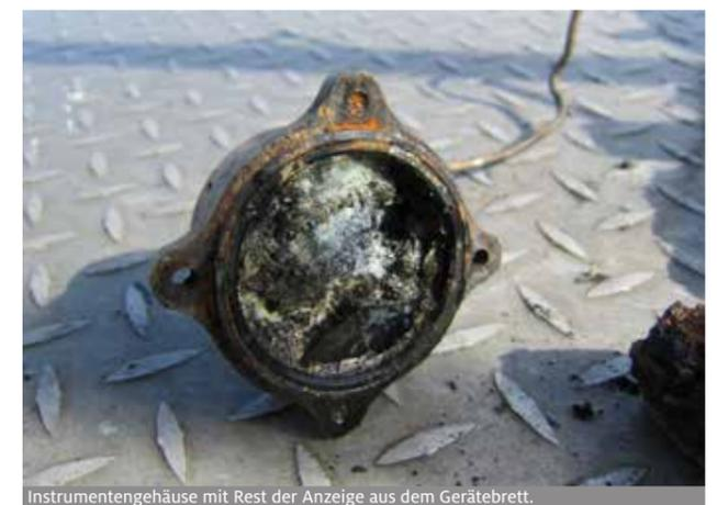
Instrumentengehäuse mit Rest der Anzeige aus dem Gerätebrett.
