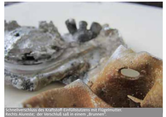
Schnellverschluss des Kraftstoff-Einfüllstutzens mit Flügelmutter. Rechts Alureste; der Verschluss saß in einem „Brunnen“.
