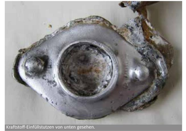
Kraftstoff-Einfüllstutzen von unten gesehen.
